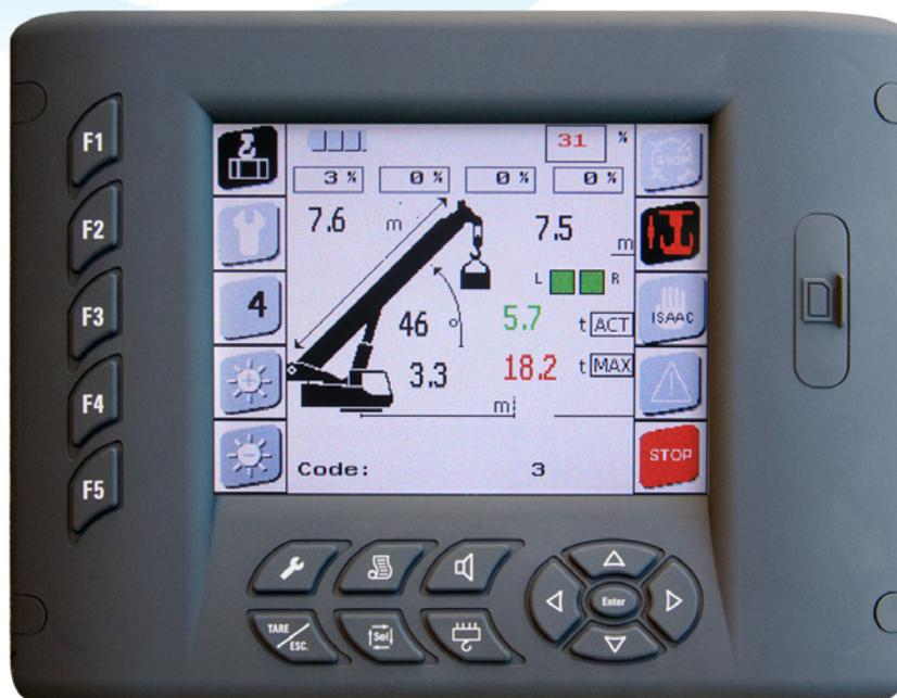
VIEW 2 è un monitor dotato di display QVGA (320x240) da 5.7" a tecnologia LED, con processore Freescale a 16 bit e acceleratore grafico integrato in FPGA. Questa architettura permette ottime prestazioni, paragonabili a dispositivi a 32 bit, ma con costi più contenuti. Dotato di tastiera integrata da 16 tasti, permette l'installazione in modalità landscape (orizzontale) o portrait (verticale).
